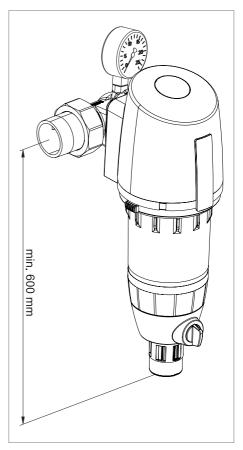
Ziehen Sie den Filter mit senkrechter Hauptachse mit Hilfe der Innensechskantschrauben druckdicht an.
