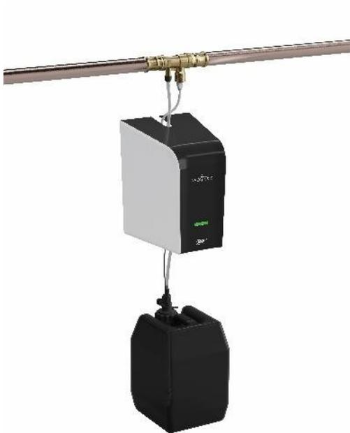
Mit ihrer elektronischen Feinststeuerung führt die neue NeoDos Connect dem Wasser eine Mineralstoffkombination zu, die die Härte des Wassers stabilisiert und in den Rohrleitungen eine Schutzschicht aufbaut. Die NeoDos Connect gehört zur SYR Connect Familie; entsprechend protokolliert und speichert sie alle Dosierdaten.
