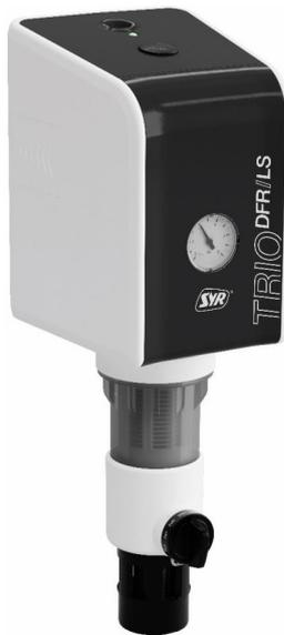
Der TRIO DFR/LS Connect — die innovative Kombination aus einem halbautomatischen, rückspülbaren Filter nach DIN EN 13443-1, einem Druckminderer nach DIN EN 1567 und einem Leckageschutz nach DIN 3553 kann platzsparend auf die NeoSoft Connect aufgef lanscht werden.
