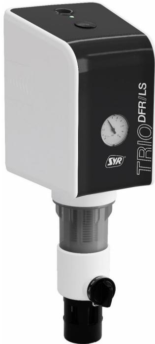
Mit dem neuen TRIO DFR/LS der Hans Sasserath GmbH & Co. KG wird aus drei Armaturen eine. Das Ergebnis ist eine innovative Kombination aus einem halb-automatischen, rückspülbaren Filter nach DIN EN 13443-1, einem Druckminderer nach DIN EN 1567 und einem Leckageschutz nach DIN 3553 in einer Armatur.
