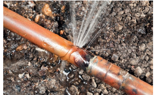
Lochkorrosion ist eine der häufigsten Ursachen für gefährlichen Rohrbruch.
